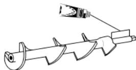
先在上图所示搅拌轴局部涂抹随机的食品机械润滑油, 再安装波纹密封圈并也要涂抹润滑油。
